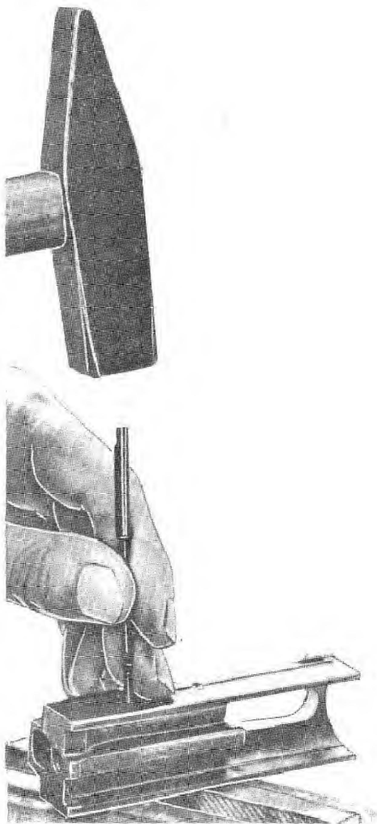
Sl. 68 – Odvajanje osovine igle od zatvarača
